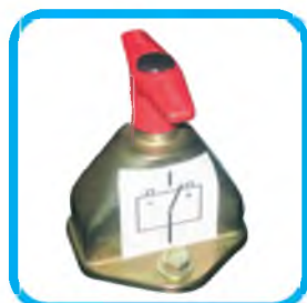
Выключатель аккумуляторной батареи
